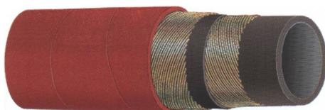
**STRUTTURA:** Sottostrato in gomma EPDM liscio nero in miscela resistente al vapore, con inserzioni di fili d'acciaio. Copertura microforata in gomma EPDM liscia rossa ad impressione tela, resistente al calore, all'invecchiamento ed agli agenti atmosferici. Per una durata maggiore drenare dopo l'uso.
