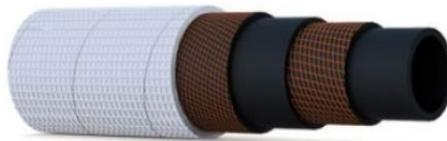
**STRUTTURA:** sottostrato liscio in gomma EPDM. Rinforzo ad alta tenacità. Copertura di fibra di silice con uno strato interno di gomma EPDM. Resistente a contatti con materiali di fonderia allo stato fuso.
