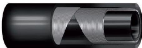
**STRUTTURA:** Sottostrato in gomma EPDM liscio nero resistente al calore. Rinforzo con inserzioni tessili. Copertura esterna in gomma EPDM liscia nera, resistente all'abrasione all'invecchiamento al calore ed agli agenti atmosferici.
