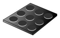
Tappeto per pavimentazioni civili e industriali a bolle realizzato in gomma costituito da uno strato di copertura con alta resistenza all'usura e da un sottostrato predisposto per l'attacco con adesivo.
