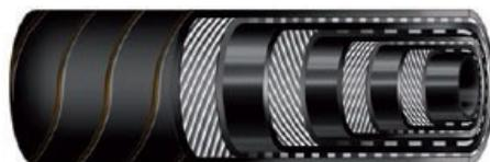
**STRUTTURA:** Sottostrato in gomma sintetica speciale liscio nero, tessuti sintetici ad alta resistenza. Copertura in gomma liscia nera ad impressione tela esterna, resistente agli agenti atmosferici, all'ozono e all'olio.
