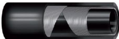
**STRUTTURA:** Sottostrato in gomma sintetica speciale liscio nero, tessuto sintetico. Rinforzo tessuti sintetici ad alta tenacità. Copertura in gomma sintetica liscia nera ad impressione tela, resistente al calore, al olio e agli agenti atmosferici.
