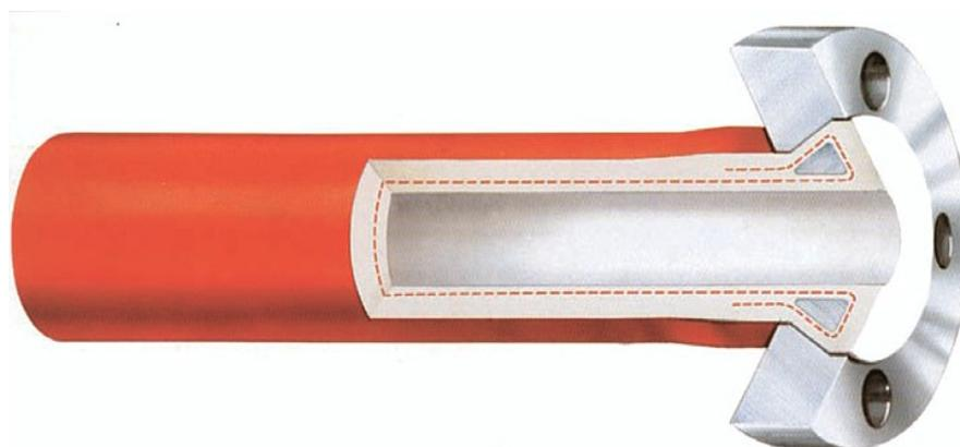
Codolo portagomma, applicato mediante vulcanizzazione, rivestito interamente con gomma fuoriuscente sulla flangia. Questo tipo di applicazione impedisce il contatto del fluido con la parte metallica del raccordo ed evita l'utilizzo della guarnizione che viene sostituita dalla gomma che riveste la flangia. Le flange possono essere fisse o mobili con foratura: DIN - UNI - ANSI ecc. e/o a disegno.
