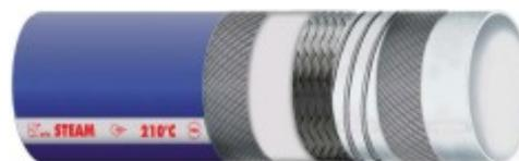
**APPLICAZIONI:** Tubo in gomma di qualità alimentare, specificamente concepito per le operazioni di lavaggio con vapore saturo (fino a +210°C) e acqua calda. Normalmente utilizzato nelle industrie lattiero-casearie, nelle latterie e negli impianti di lavorazione di alimenti, per consentire massima sicurezza durante i processi di pulizia con acqua calda e vapore. Impiego in mandata.
