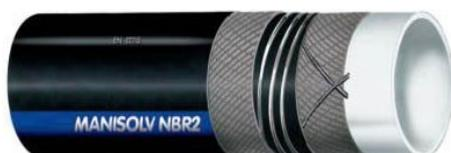
**STRUTTURA:** Sottostrato in gomma chiara, liscio. Rinforzi tessili sintetici ad alta resistenza, spirale in acciaio incorporata, cavetti di rame inseriti per assicurare la dissipazione dell'elettricità statica. Copertura in gomma NBR nera, anti-statica ( $R < 10^6 \text{ Ohm/m.}$ ) resistente all'abrasione, all'ozono, agli agenti atmosferici, ai grassi e agli oli minerali, liscia, impronta tela.
