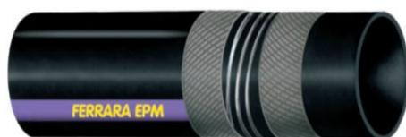
**STRUTTURA:** sottostrato in EPM. (COPOLIMERO ETILENE PROPYLENE). Nero liscio. Rinforzo Inserzioni tessili sintetiche, ad alta resistenza, spirale in acciaio incorporata. Su richiesta cavetti di rame inseriti. Copertura Gomma EPDM nera, anti-statica ( $R < 10^6 \text{ Ohm}$ ), resistente all'abrasione, all'ozono e agli agenti atmosferici, liscia, impronta tela.
