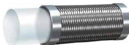
**STRUTTURA:** PTFE liscio, resistente alle sollecitazioni meccaniche, vibrazioni, bassa permeabilità, dielettrico, antifiama, alimentare (approvato FDA, DVGW, BFR). Chimicamente inerte, antiaderente, resistente all'ozono ed all'invecchiamento atmosferico. Rinforzato trecce in acciaio inox ad alta tenacità AISI 304.
