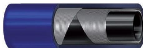
**STRUTTURA:** Sottostrato in gomma EPDM liscio nero di qualità alimentare resistente al calore. Su richiesta EPDM bianca. Rinforzo tessuti ad alta tenacità. Copertura blu, liscia in gomma EPDM, resistente all'abrasione all'ozono e agli agenti atmosferici.
