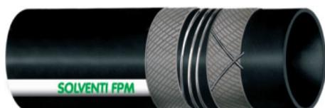
**STRUTTURA:** Sottostrato in FPM-FKM (VITON ESAFLUORO PROPYLENE VINILIDENE FLUORIDE). Neutro, liscio. Rinforzo inserzioni tessili sintetiche, ad alta resistenza. Spirale in acciaio incorporata. Cavetti di rame inseriti. Copertura in gomma CR nera, antistatica ( $R < 10^6$  Ohm), resistente all'abrasione, agli agenti atmosferici, all'ozono e all'invecchiamento, liscia, impronta tela.
