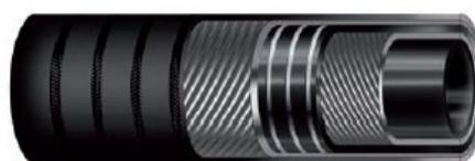
**STRUTTURA:** Sottostrato in gomma NBR liscio nero. Rinforzo con inserzioni tessili ad alta tenacità, spirale metallica incorporata. Copertura in gomma SBR/NBR/PVC antistatica grecata nera ad impressione tela esterna resistente agli oli, all'abrasione e agli agenti atmosferici.
